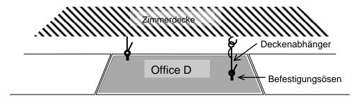
Abhänger an Decke befestigen und das Heizelement einhängen.
