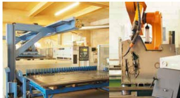
MAZAK Laserschneidmaschine, Schweißroboter
