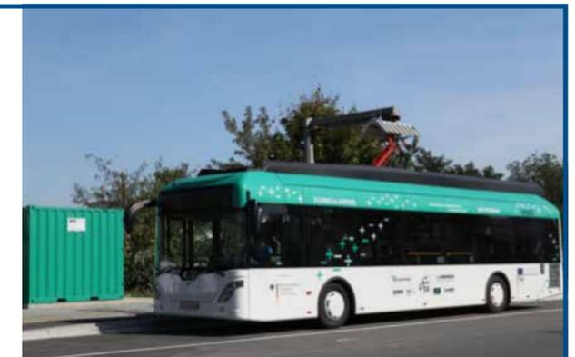
Laden Batteriebus an Schnellladestation Dresden Gruna
